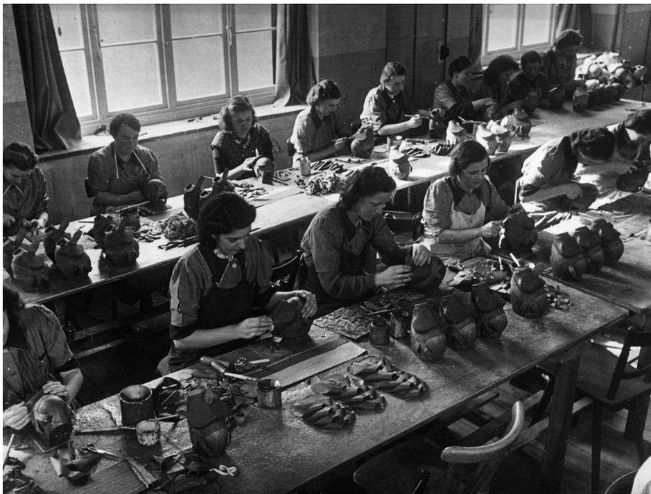
Quelle: Herstellung von Gasmasken in den Skara-Gummiwerken. Foto: Gerd Mingram (Germin).
